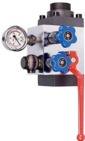
La válvula de seguridad puede mantener la presión del sistema al valor ajustado. Cuando la presión sobrepasa el valor ajustado, la válvula de seguridad se abre para evitar la sobrecarga. Es especialmente importante para el sistema del cierre para reducir al mínimo el daño al sistema que resulta del aumento repentino de carga. Características: estructura compacta, tamaño pequeño, caja fuerte y conveniente, operación simple.
