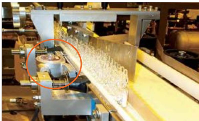
El modelo de vibrador de turbina VS de VIBCO funciona igualmente bien en aplicaciones para tolvas (arriba a la izquierda) o para transportar frágiles envases de vidrio para vacunas, como está haciendo la turbina silenciosa VS-100 (arriba) sin roturas ni atascamientos.
