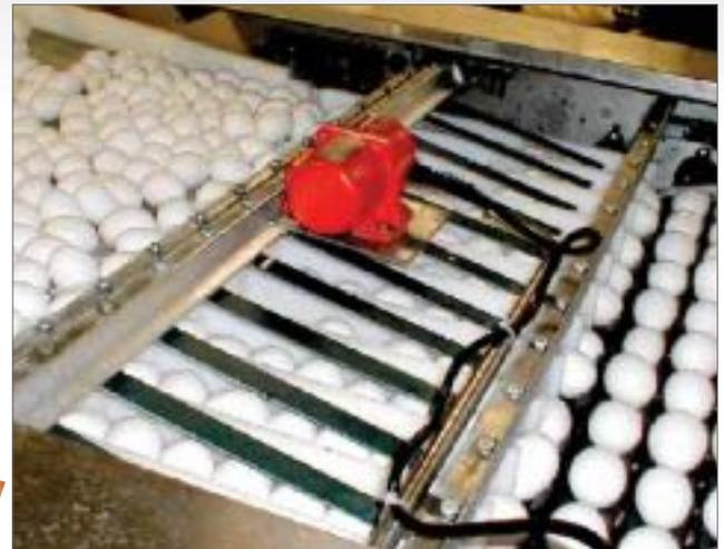
Arriba: Las unidades SCR son ideales para recipientes, conductos, empaque, cribado y mesas de ensayo en condiciones exigentes. Sin embargo, el Modelo SCR-60 también se puede usar con una potencia y frecuencia lo suficientemente delicadas como para separar la clara de la yema sin terminar con huevos revueltos.
