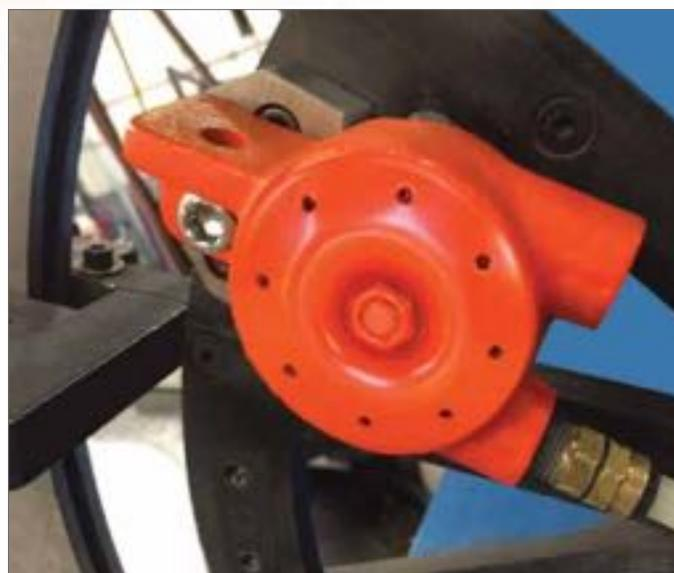
Los FBS-100, 130, 160 y 190, con silenciadores integrados, están diseñados como vibradores de placas combinadas para la industria de la fundición y tienen arranque rápido con muchas r.p.m., alta potencia y bajo nivel de ruido con un silenciador integrado. Los vibradores de placas combinadas solo se deben usar para servicio intermitente.
