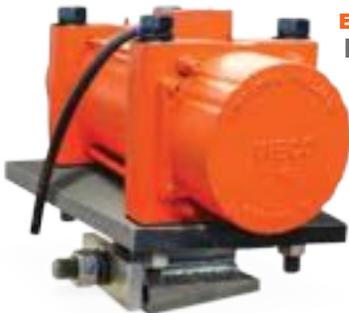
El Modelo VMW de VIBCO consta de un Vibrador 2P o 4P con una ménsula estilo cuña. Estos vibradores eléctricos de alta resistencia, Modelo 2P (3600 r.p.m.) y Modelo 4P (1800 r.p.m.) produce mucho torque y amplitud. Todos los modelos tienen protección contra sobrecargas y excéntricas ajustables que aporta flexibilidad para
