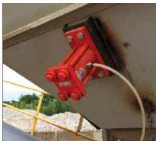
Los Vibradores de pistón VIBCO brindan alto impacto y una transferencia de energía eficiente para asegurar el flujo de materiales sin inconvenientes a través de los recipientes, las tolvas, los dosificadores de peso y otros.
