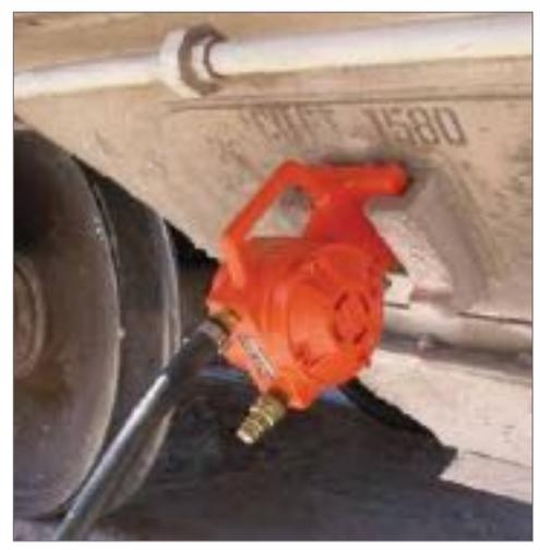
La unidad CCW-5000 de la imagen se ajusta a la ménsula acuñada hembra estándar para vagones con el fin de descargar con facilidad los vagones mezcladores de ferrocarril.
