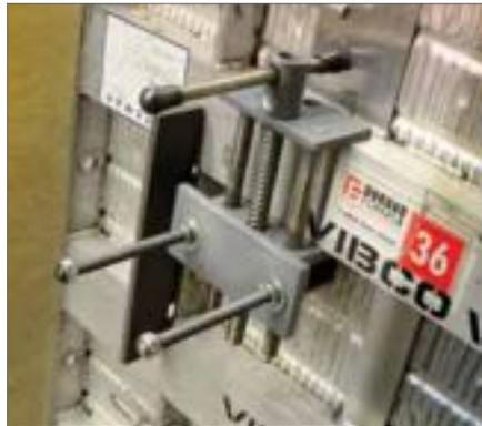
La ménsula para encofrados VIBCO se puede usar para encofrados para paredes de madera, plástico, fibra de vidrio y metal.
