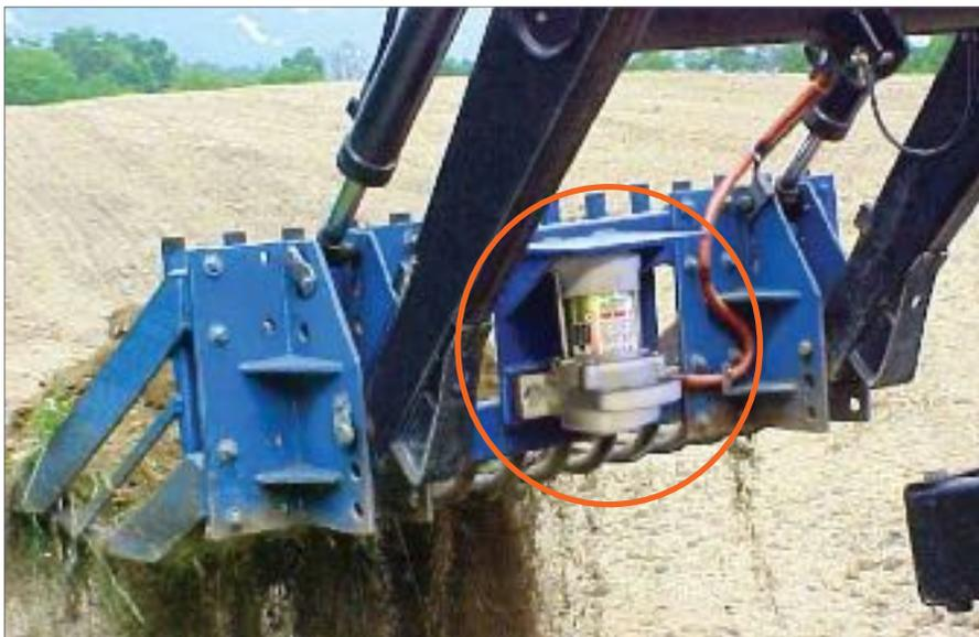
Arriba: Un **Big Bertha** se utiliza en una excavadora para retirar grandes rocas y vegetación de un sitio de trabajo y al mismo tiempo dejar el suelo en el lugar (ver páginas 48 y 49). Abajo: El **DC-3500, Big Bertha** de VIBCO se ajusta con firmeza debajo del volquete basculante de un camión y cuenta con todas las conexiones eléctricas necesarias para instalarlo y operarlo con efectividad.
