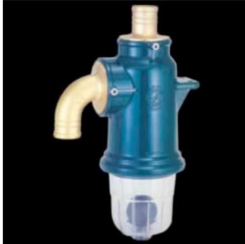
La válvula funciona como cierre secundario en el caso que el nivel de líquido sobrepase la capacidad del estanque, también captura partículas y líquidos para proteger la bomba de vacío. En la parte inferior esta provista de una válvula de bola para el despacho de líquido.
