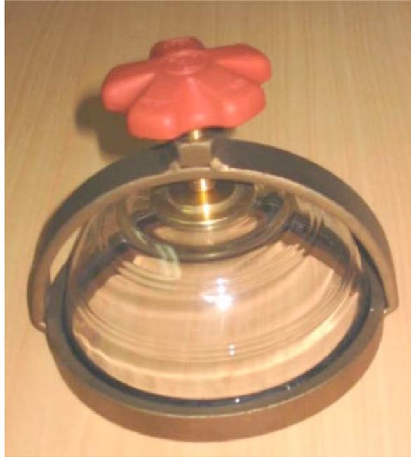
La mirilla de inspección está fabricado con una media esfera en material de vidrio y el soporte en acero. Girando la perilla superior es factible demontar la semiesfera.
