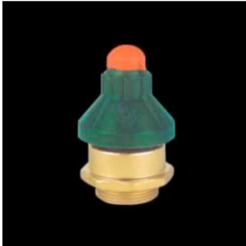
La válvula funciona como protección de la instalación de vacío permitiendo la entrada de aire a una presión ajustable, deseada. La válvula está ajustada en la fábrica a  $-0,6$  bar.
