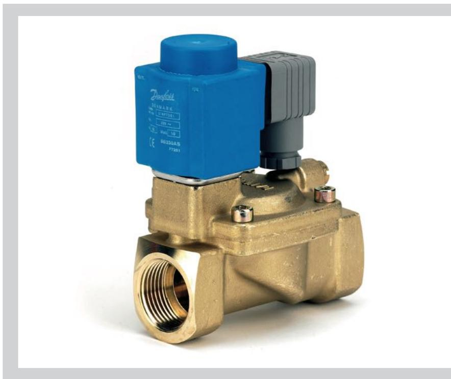
La gama EV220B 15–50 se compone de válvulas solenoide universales, servoaccionadas e indirectas de 2/2 vías. Todas ellas están disponibles con cuerpo de latón, latón resistente a la desgalvanización (latón DZR) y acero inoxidable, lo cual garantiza su validez para un amplio abanico de aplicaciones. Cuentan, además, con filtro piloto integrado, tiempo de cierre ajustable y protección hasta IP 67 para optimizar su rendimiento incluso en condiciones de trabajo extremas.
